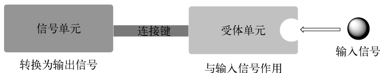
图 2-1 荧光分子传感器的基本结构
