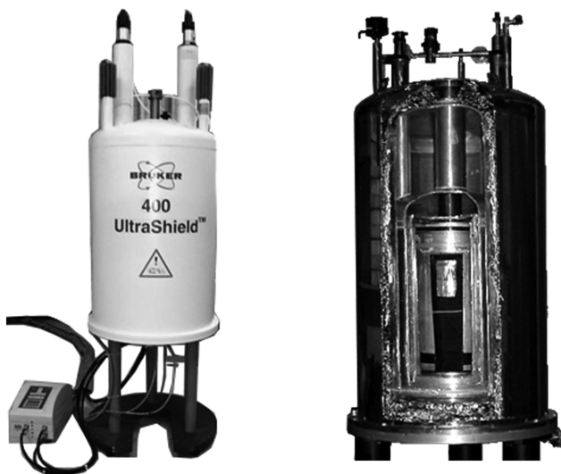
图1.1 液体核磁共振波谱仪磁体及内部结构(Bruker 公司生产的 Advance II 400 MHz)
